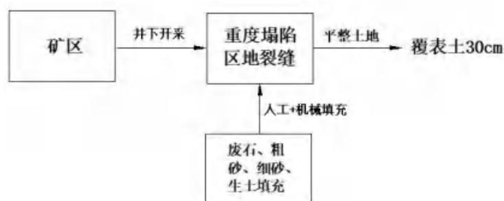
图 6-2-8 重度塌陷区裂缝处理示意图
