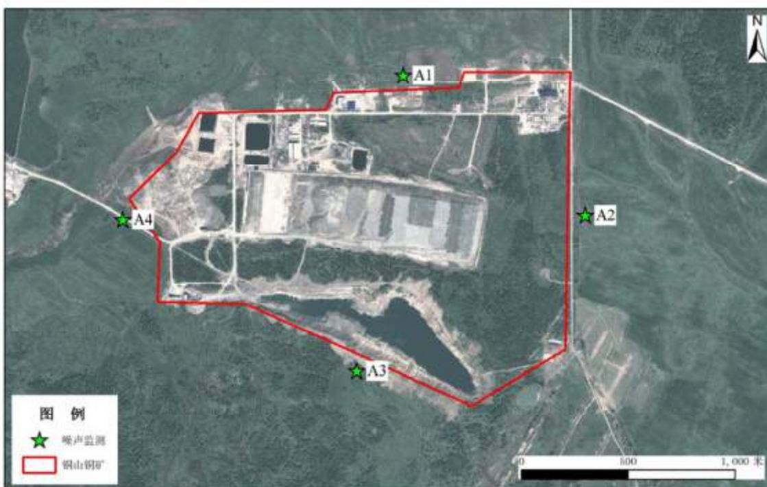
图 3.4-1 噪声监测点布置示意图
